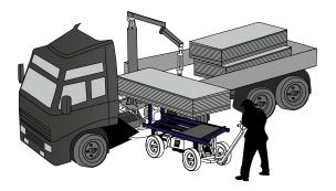
Der ErgoMover 1500 Manipulator kann Gipskartonplatten sowohl Horizontal auf Böcke abstellen – als auch aufrecht in der ErgoLoader (Gestell für Lagerung und Transport der Gipskartonplatten).
