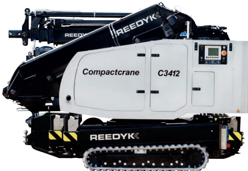
Der Reedyk C3412 misst nur 298 x 202 x 96 cm. Durch die robusten non-marking Gummiketten dreht er auf der Stelle, der Fahrtrieb wird per Funksteuerung gesteuert. Somit erreicht man mit diesem kompakten Kran auch die engsten Stellen wo andere schon längst versagen.
