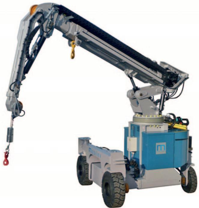
Das Modell 25MT 3x3 TC ist der erste elektrische geländegängige Minikran mit Allradantrieb und -lenkung. Er verfügt über eine Vorderachse mit 90° Einschlagwinkel der Räder und ist somit für „Krebstgang“ ausgelegt, über leichtgängige Räder mit Vollgummibereifung für Innen- und Außenbereiche sowie über die Option 40° Drehkranz, um schnell die laterale Ausrichtung des Hakens zu korrigieren.
