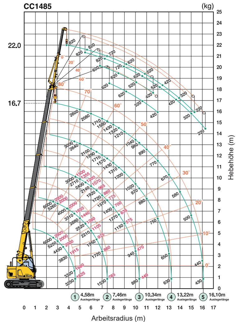
Das Arbeitsbereich-Diagramm zeigt die Gesamtnennlast einschließlich der Reichweite des Auslegers und der Kranspitze.
