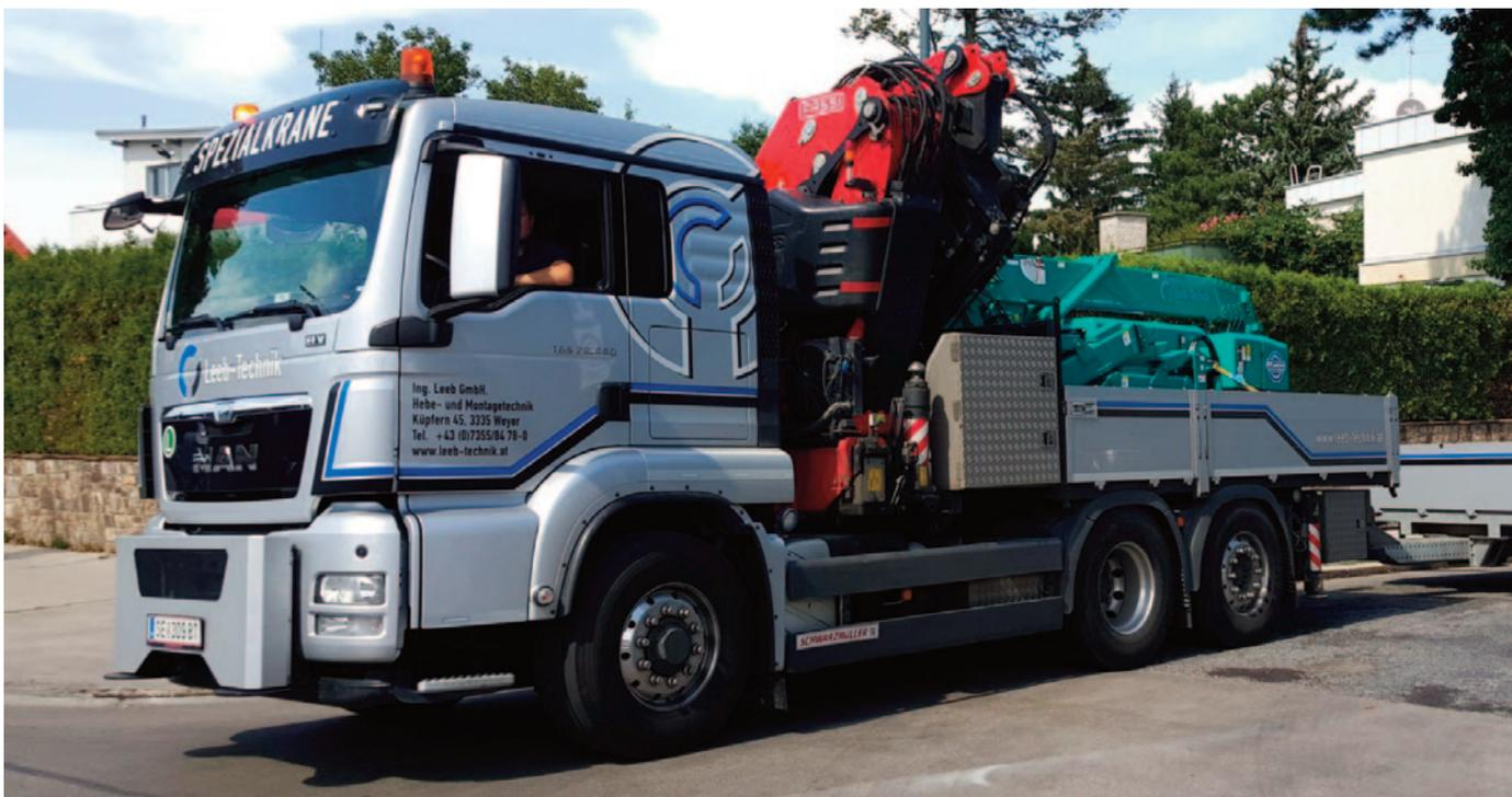
Der MAN 3-Achs LKW mit FASSI 560 RA Ladekran und einer 4 m Ladepritsche für weiteres Equipment wie Mini-krane, diverse Glasmontagegeräte, Spezialsauger usw. ist durch seine Bauweise äußerst kompakt und wendig und passt auch durch knappe Einfahrten und Hallen! Überzeugende Hubleistung und äußerst feinfühliges Bedienung via Funkfernsteuerung bieten perfekte Performance beim Heben und Montieren von Glas, Stahl, Holz oder sonstigen Materialien.
