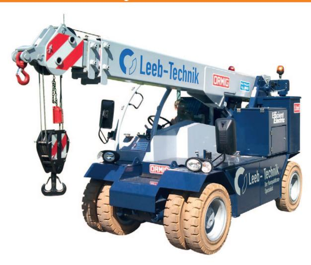
Der Ormig 5.5 tmE Pick & Carry Kran stellt den kleinsten Industriehofkran des renommierten italienischen Herstellers dar. Mit nur 6.7 to Eigengewicht, einer frei verfahrbaren Last von 5.5 Tonnen und Elektroantrieb ist dieser Kompaktkran die perfekte Alternative bei Umschlagarbeiten, in der Industriemontage oder in der Instandhaltung von z. Bsp. Produktionsstraßen.
