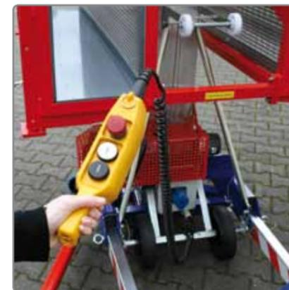
Eine Kabelfernbedienung\* sorgt für einen höheren Bedienkomfort.
