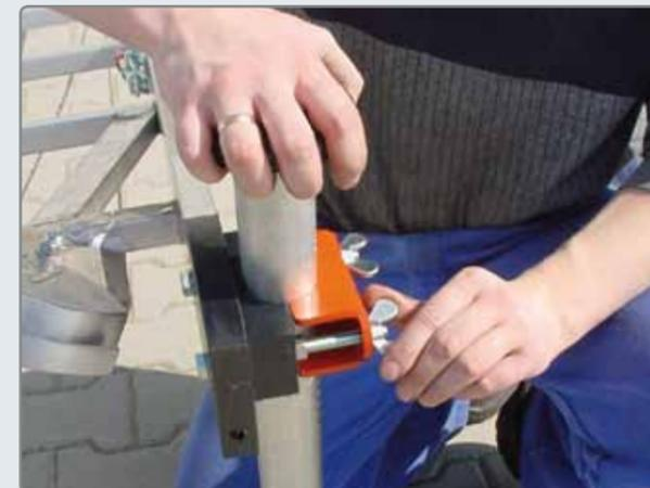
Die seitlichen Stützen werden mittels Flügelmuttern fixiert.
