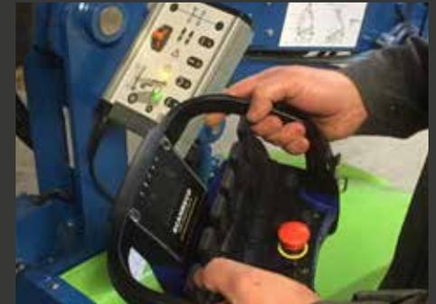
Das Multifunktions-Bedienpaneel in bedienerfreundlichem Design mit integrierten Bedienknöpfen und Signalleuchten, doppelt gesicherte Sicherheitsschalter gehören zur Standard-Ausrüstung des Winlet 575.
