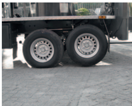
Hochleistungsfahrantrieb mit absenkbarer Hinterachse ermöglicht leichtes und einfaches Rangieren mittels Funkfernsteuerung!
