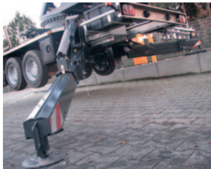
Flexible Abstützung durch einzeln klapp- und teleskopierbare Stützen, optional automatische Selbstnivellierung über Funkfernsteuerung!
