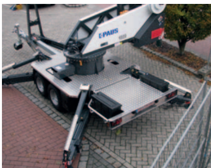
Auch bei schmaler Abstützung und unter Vollast 360° endlos drehbar
