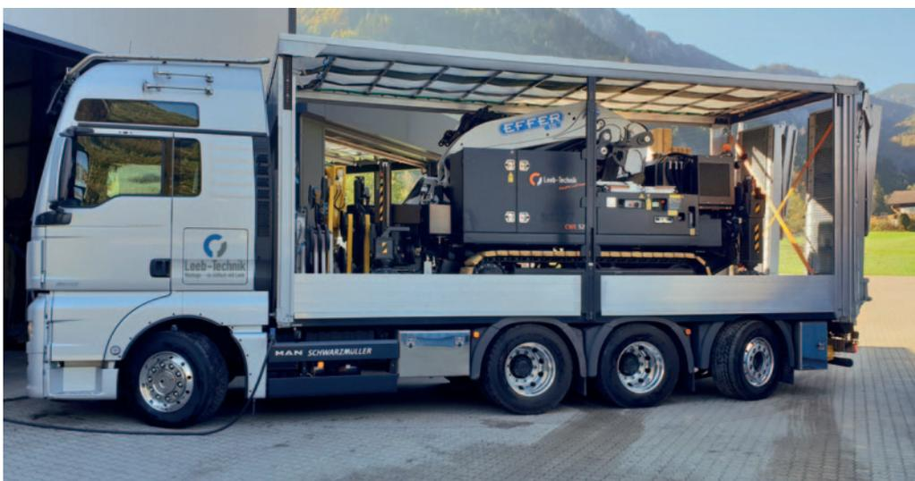
Spezieller 4-Achs MAN LKW mit Laderampen zum schnellen und wendigen Transport des CWE525 und anderer Minikrane.
