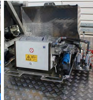
230 V E-Antrieb mit Tandempumpe
