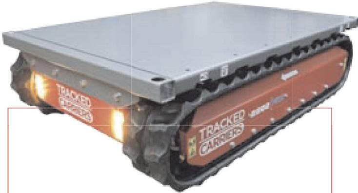
Die 2200-Serie von Tracked Carriers ist perfekt für den Transport schwerer Güter durch beengte Räume. Die Modelle 2200 R und 2200 PRO sind Schwergewichte in einer kompakten Verpackung mit einer Breite von nur 950 mm. Die Tracked Carriers-R-Modelle sind natürlich auf dem neuesten Stand der Technik: Einfach zu bedienen, zuverlässig und leicht zu warten.
